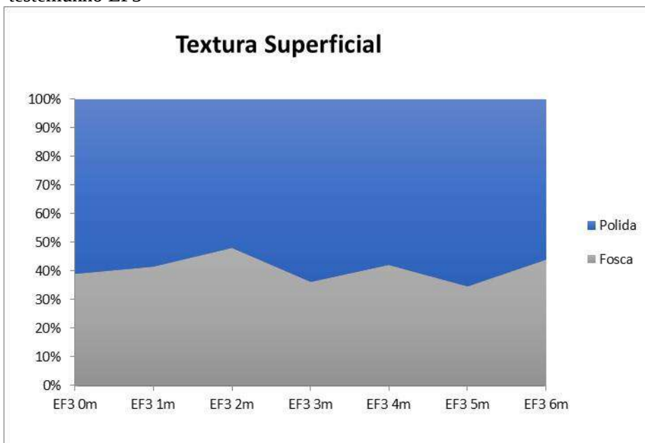
Figura 16: Textura superficial dos grãos das amostras analisadas no testemunho EF3
