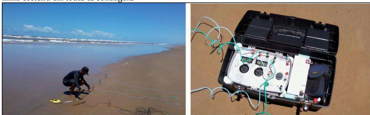
Figura 2: Controle do espaçamento entre eletrodos com auxílio de uma trena e resistivímetro utilizado nos levantamentos. O alinhamento dos eletrodos foi mantido aproximadamente paralelo à linha costeira em todas as sondagens
