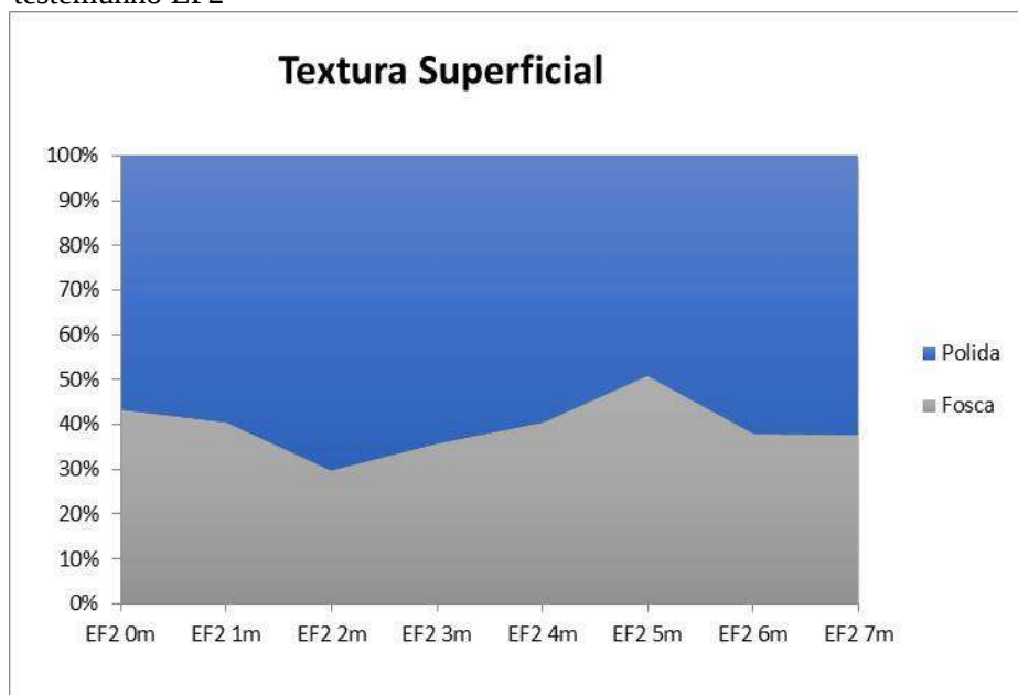
Figura 15: Textura superficial dos grãos das amostras analisadas no testemunho EF2
